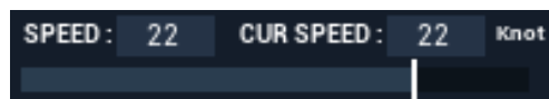
รูปที่ 4.37 แผงควบคุมความเร็วที่ความเร็ว 22 นอต
